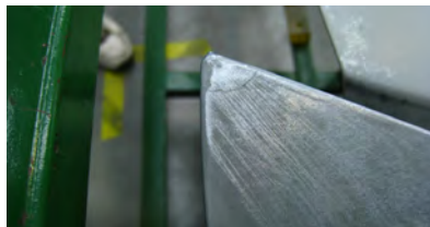
图1 后盖角部塌陷
