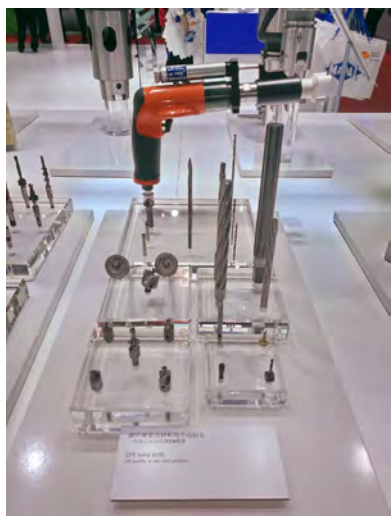
图57 玛帕的碳纤维复合材料手用钻头
