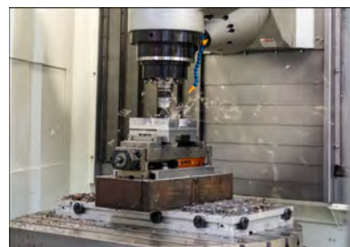
效率：TNC的AFC（自适应进给控制）功能结合摆线铣削功能
