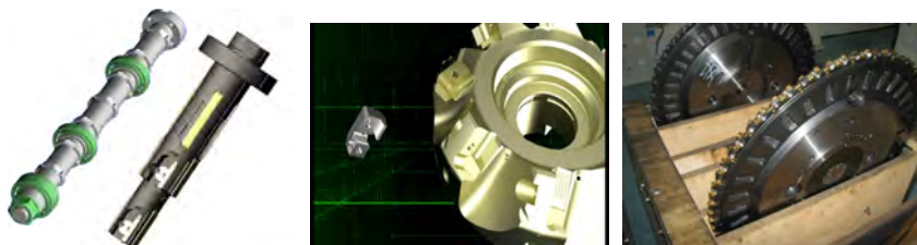
图54 自左至右为线镗刀、曲轴孔精加工铰刀、铝合金高速面铣刀盘、曲轴高速外铣刀
