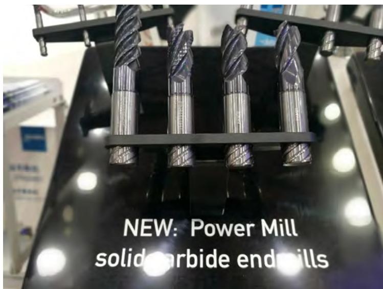
图25 翰默带安全锁结构的整体硬质合金铣刀
