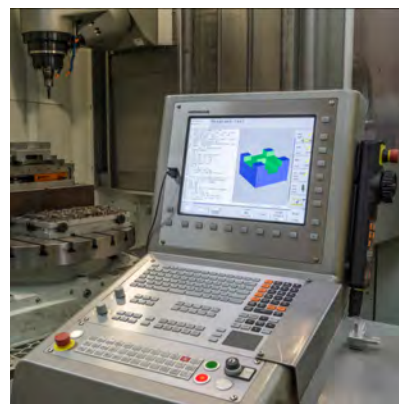
保值：海德汉iTNC 530数控系统的AFC软件选装项保护刀具和机床。
