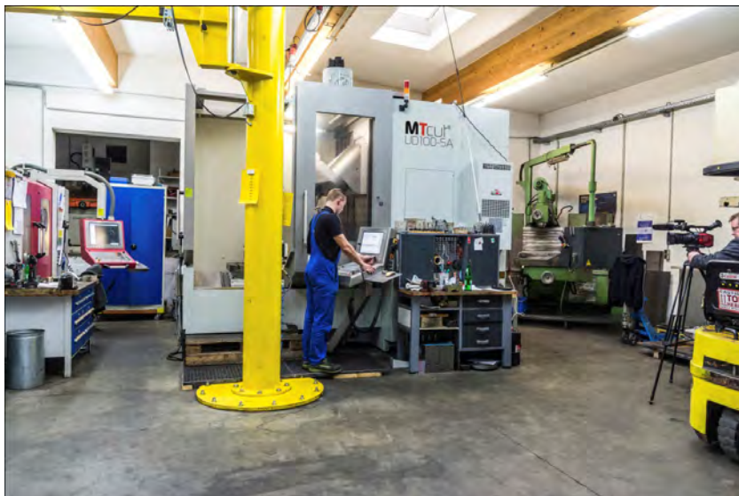
高性能和高精度：MTRent的UD100-5A 5轴万能加工中心配海德汉iTNC 530
