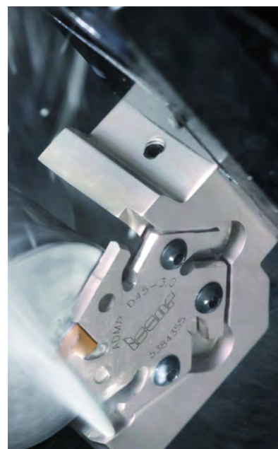
图7 伊斯卡TANG-GRIP立装自夹式五边形切槽车刀
